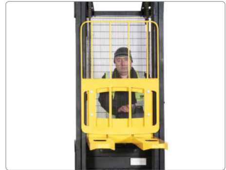
Ausgezeichnetes Sichtfeld durch das Hubgerüst
