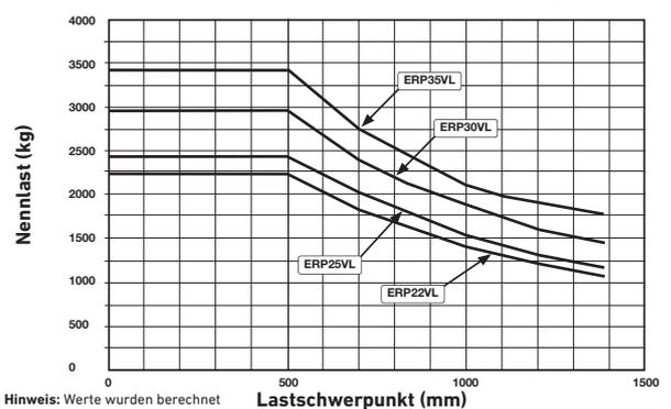
Berechnungen basieren auf: 5.100 mm (ERP20-25 VL mittlerer Radstand), 4.650 mm (ERP25VL langer Radstand) oder 4.460 mm (ERP30-35 VL) Dreifach-Hubgerüst mit Vollfreihub mit 1.067-mm-Standardgabelträger und Lastschutzzitter
